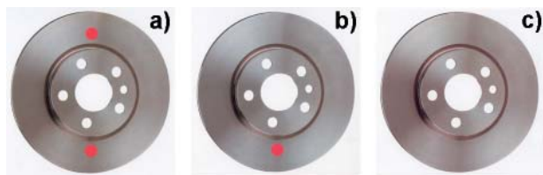
Rys.4 Pomiar różnicy grubości części roboczej tarczy hamulcowej, można próbować wykonać za pomocą śruby mikrometrycznej. (Źródło: Continental Teves A.G.)
