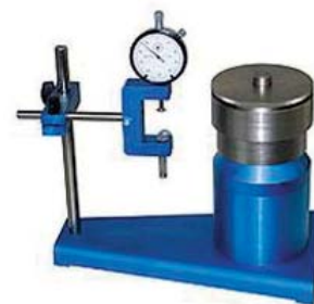
Rys.3 Przyrząd oferowany przez firmę ATE, do pomiaru bicia osiowego oraz różnicy grubości części roboczej wymontowanych tarcz hamulcowych. (Źródło: Continental Teves A.G.)
